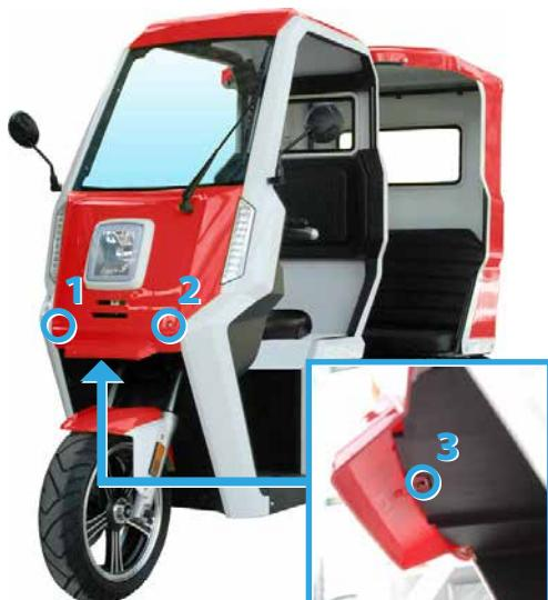
2. ワイパー付け根のカバーを上げ、ナット（10mm）を外します。続いてワイパーを取り外し、ナット（19mm）を外します。
