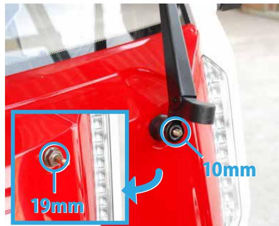
3. フロントカウルを下方向にずらして取り外し、ウォッシャータンクに液を補充します。
