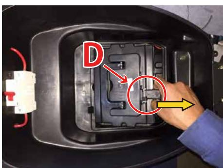
④ D(上段バッテリーのケーブル)を引き抜きます。
