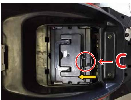
③ Cの部分を黄色の矢印の方向に持ち上げ、ケーブルロックを外します。
