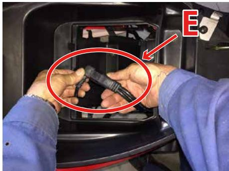
⑥ Eの部分(二股ケーブルと本体のケーブル)を抜きます。
