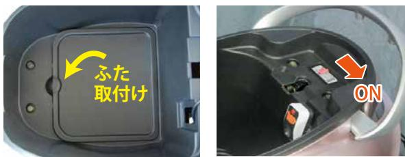
4. バッテリー収納ふたを取り付け、ブレーカーを ON にします。
