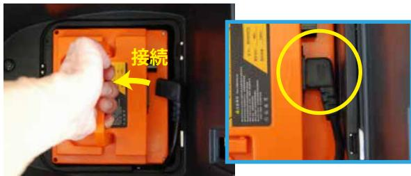
3. 取り外したときと逆の手順で、バッテリーを取り付け、電源ソケットを接続します。
