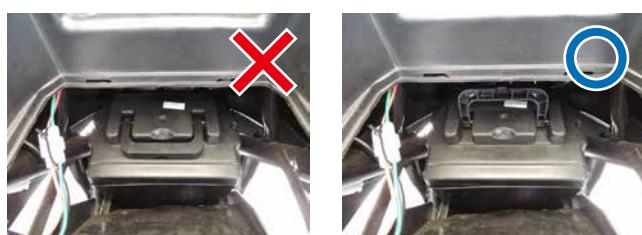
※バッテリー収納時には下のバッテリーの持ち手を立てて収納してください。
