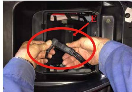
⑥ Eの部分(二股ケーブルと本体のケーブル)を抜きます。
