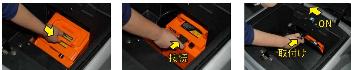
4. バッテリー収納ふたを取り付け、ブレーカーを ON にします。
