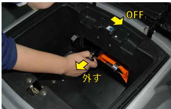
1. トランクを開け、ブレーカーを OFF にします。続いてバッテリー収納ふたを外します。
