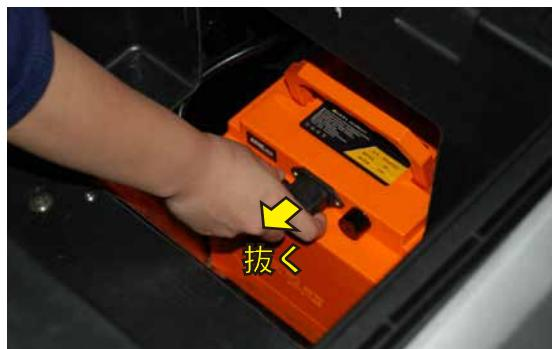
2. バッテリーから電源ソケットを抜きます。
