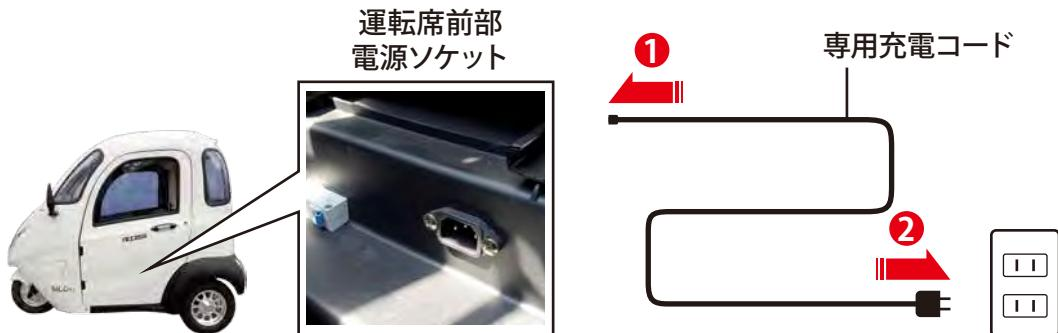
1. 座席前方下の電源ソケットに専用充電コードを接続します。
